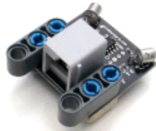
*Double capteur infrarouge*
