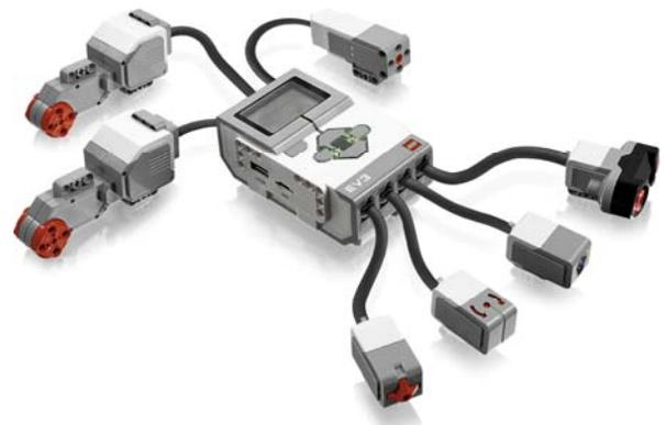
Actionneurs, capteurs et boîtier de commande Lego EV3
