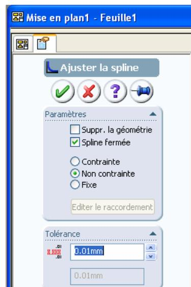
*Remarques* Contrairement aux contraintes géométriques classiques, les contraintes géométriques créées entre une entité spline et une autre entité sont des contraintes limitées à l'étendue géométrique de la spline. Cette technique peut être utilisée pour arrêter le mouvement d'un mécanisme à des positions limites.
